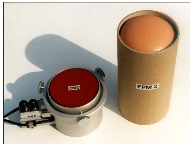
Bild 3: Mit dem Polarisations-Sensor CMD wird die Dielektrische Polarisation einer Schaumprobe in Kombination mit dem Steigdruck gemessen. Der Polarisationsensor ist auf der Druckplatte montiert. Rechts die Schaumprobe in der abgenommenen Kartenhülse.
