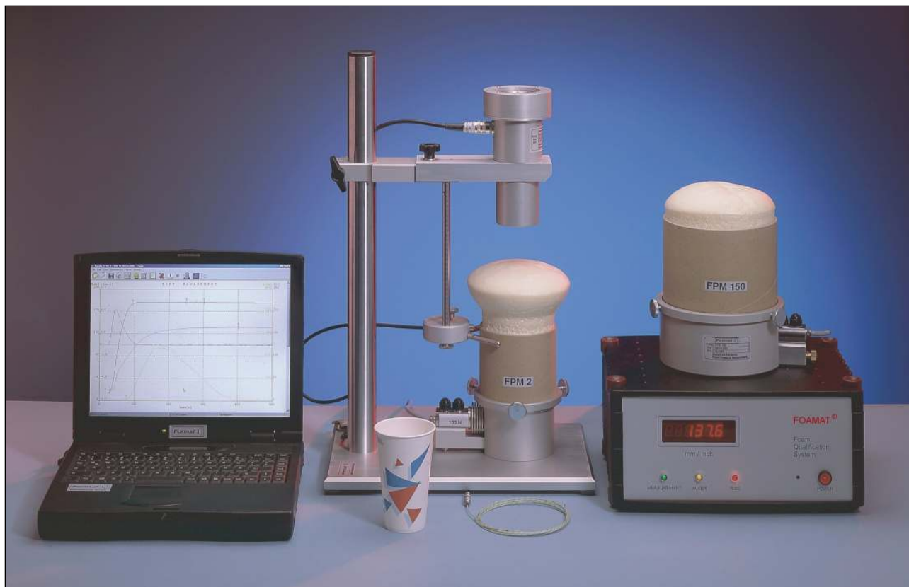
Bild 1: Das Schaumqualifizierungssystem FOAMAT besteht aus einer Messmechanik mit dem Ultraschall Gebläsesensor PFT, den Druck-Messeinrichtungen FPM 2 bzw. FPM 150 und einem Steuergerät. Die Reaktionstemperatur wird mit einem Thermoelement gemessen. Das Programm SCHAUM steuert die Benutzerführung, den Messablauf und die Datenverarbeitung.
