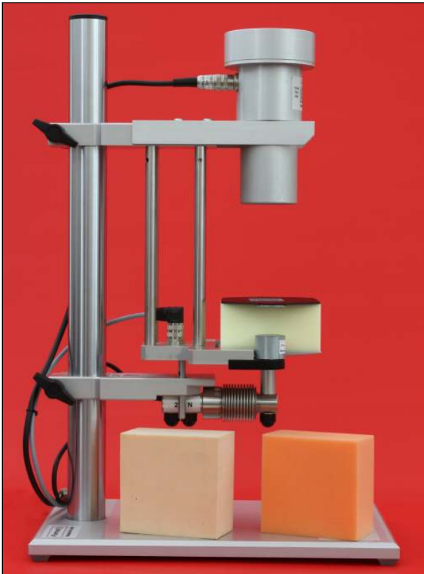
Bild 11: Aufbau des Prüfgeräts Resimat für die Untersuchung des Druck- und Entspannungsverhaltens von viskoelastischen Schaumstoffen.
