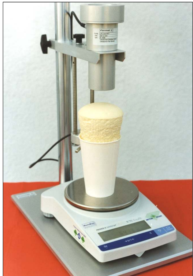
Bild 5: Der Gewichtsverlust wird mit einer in das FOAMAT System integrierten Laborwaage gemessen. Der im Rührbecher verbleibende Schaumrest wird hierfür verwendet.
