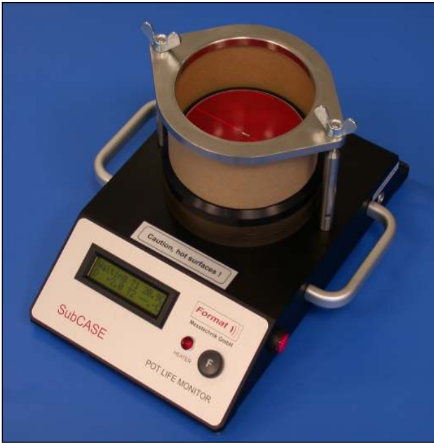
Bild 8: Messgerät SubCASE zur Bestimmung der Topfzeit und der Aushärtung von Beschichtungen, Klebern, Vergussmassen und Elastomeren. Der Reaktionsverlauf wird durch Messung der Dielektrischen Polarisation und der Reaktionstemperatur ermittelt.
